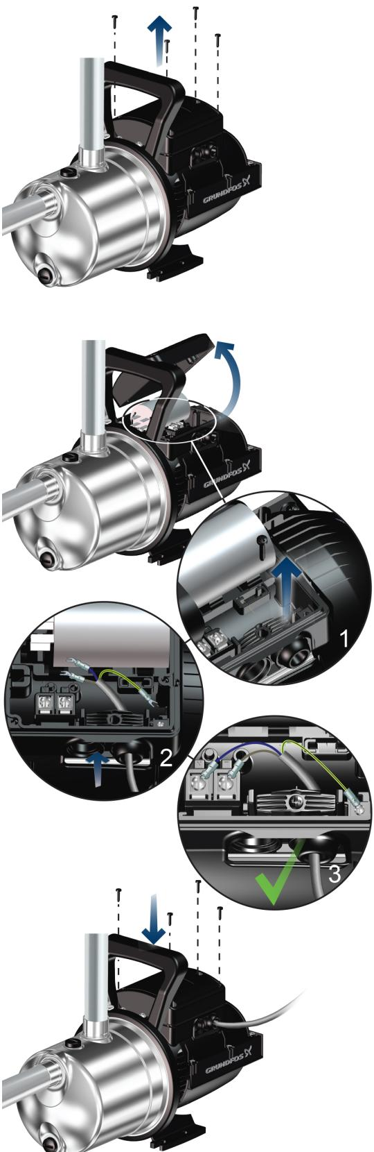
6. Kabelske prevodnike priključite na napajalni terminal. Glej diagram ožičenja.
