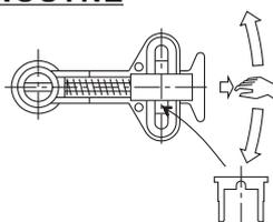
Varnostna sklopka z vilicami, ki se ob preobremenitvi pogona zlomijo, preprečuje okvaro elektromotornega pogona.
