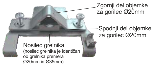
Nosilec grelnika z objemko za električni grelnik premera Ø 20 mm
